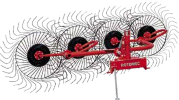
kompakter und gleichförmiger Ballen geformt werden kann. Die Zinken sind für einen sanften und sauberen Kontakt mit dem Futter aus Federstahl. Die schmierbaren Radnaben an den Rotomec Sternspinn-Rechwenden sind aus Stanzstahl und enthalten Kegelrollenlager, die eine besonders hohe Lebensdauer der Radnabe garantieren.
