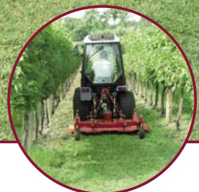
la transmission. Le Cyclone C30 utilise le bras porte-roues robustes imprimés et renforcés et est équipée d'un attelage trois points oscillant qui permet à la tondeuse de mieux suivre les irrégularités du terrain.
