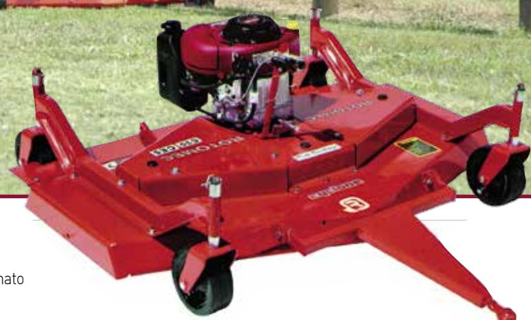
**I** Il C30-CE5 è un rasaerba trainato o spinto a tre giranti con scarico dell'erba posteriore, azionato da un motore a scoppio e quindi destinato a trattorini sprovvisti di presa di forza e ai quadricicli ATV. Il motore è un Briggs & Stratton da 10,5 HP dotato di frizione centrifuga con dispositivo d'arresto per la sicurezza. L'altezza di taglio varia da un minimo di 2,5 cm ad un massimo di 10 cm ed è regolabile aggiungendo o togliendo i distanziatori presenti su ciascuna delle forcelle ruota.
